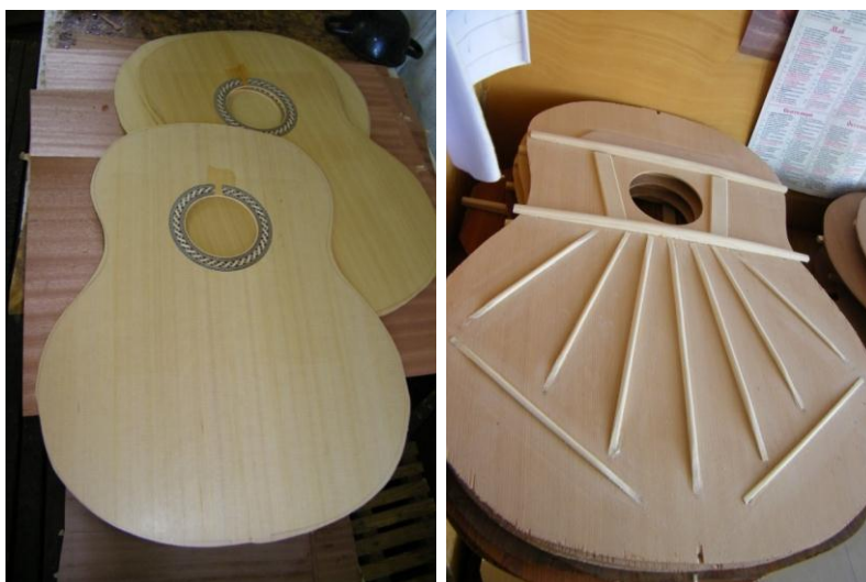
Фиг. 1. Общ вид на дек: платно (вляво) и оребряване (вдясно)
