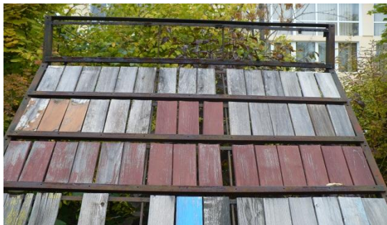
Фиг. 3. Външен вид всички пробни тела след 4 години експониране в атмосферни условия.
