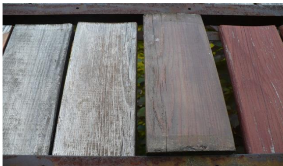
Фиг. 4. Характерни разрушения на акрилатно покритие експонирано в атмосферни условия в продължение на четири години. Ляво – разрушение на изложената повърхност; дясно – гръб на пробното тяло.
