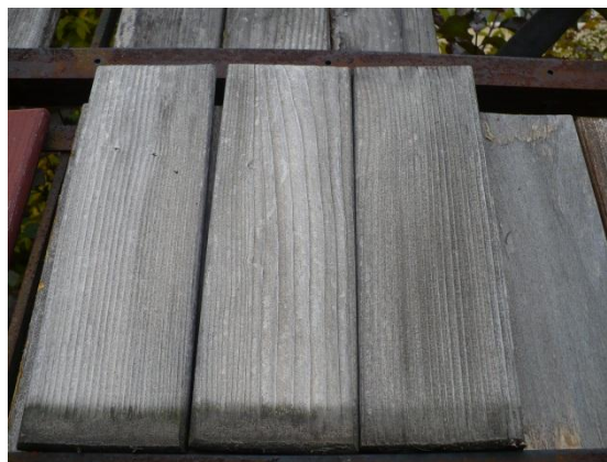
Фиг. 5. Характерни разрушения на термично третирана дървесина, експонирана на открито в продължение на 4 години.
