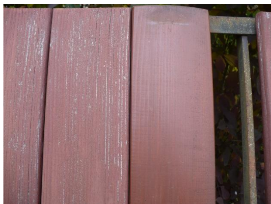
Фиг. 6. Характерни разрушения на алкидно покритие, експонирано в атмосферни условия в продължение на четири години. Ляво – разрушения откъм изложената повърхност; дясно – гръб на пробното тяло.
