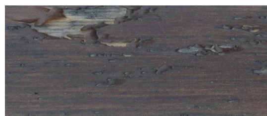
Фиг. 2. Разрушения на покритието формирано върху пробно тяло HTSrR-2 след 2 години експониране в атмосферни условия.
