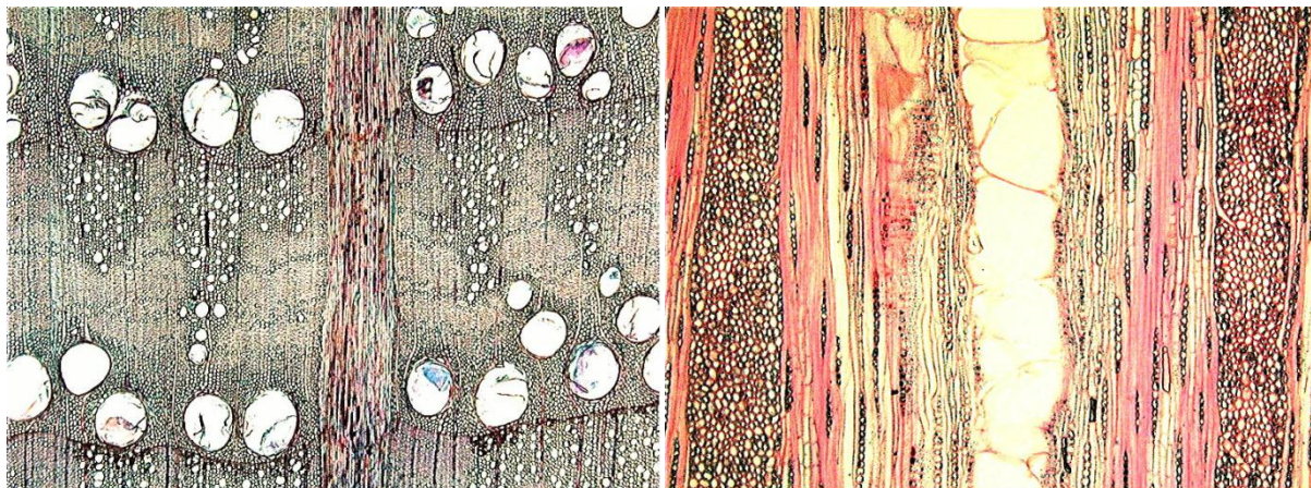
Фиг. 1. Анатомичен строеж на дървесината на зимен дъб. а) напречен разрез (вляво), б) тангенциален разрез (вдясно) (Dallwitz, M. J., 2011)
