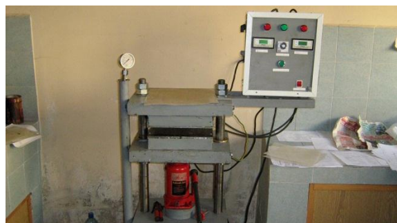
Фиг. 2. Едноцилиндрова хидравлична гореща лабораторна преса.
